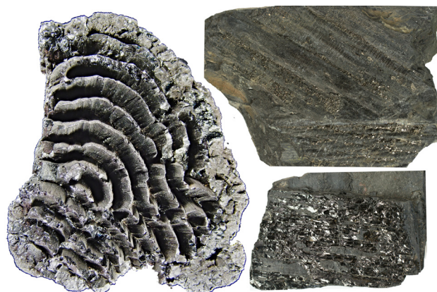
Obr. 3 a - příklad prouhelnění kmene z černého uhlí s uchovanými letorosty vyplněný vitrinitem stejným jako v okolní masě uhlí, který nevznikl z rostlinného detritu, Svatoňovice. Sbírky Jihočeského muzea (P.HP. 64), b, c - přednostní porušení černouhelných mm mocných vitrinitových proplátek kliváží zvyšuje jejich propustnost pro uhlovodíky (Zbůch). Rozměry, vzorek a (10 x 11,3 cm), vzorek b (18 x 14 cm), vzorek c (11,5 x 9, 5 cm)
